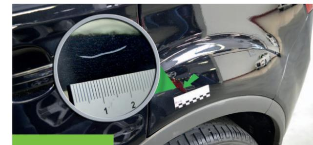
... und laufeistungskonforme Schäden wie kleine Kratzer oder Beulen.
